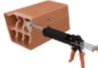
4. Remplir du fond vers l'extérieur en reculant d'une graduation sur la buse à chaque pompée.
